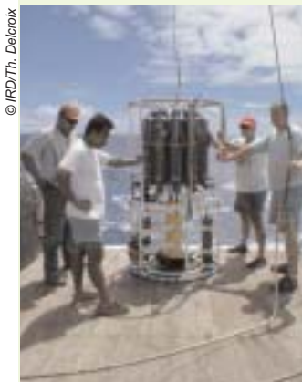
La bathysonde et le courantomètre (en jaune) utilisés pendant ces campagnes.
